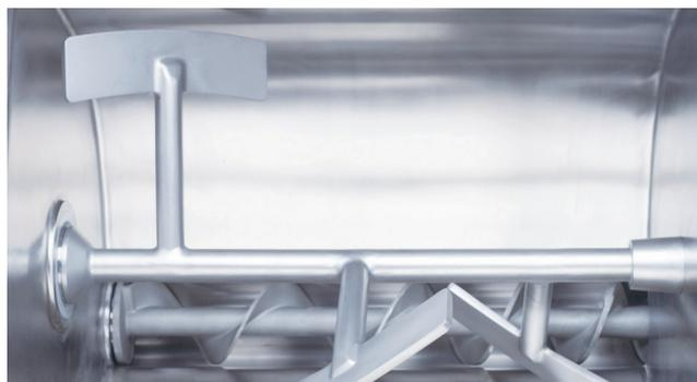
Unger切割系统的绞肉机可以选配效果卓越的去筋膜装置，此装置可以有效的分离肉中的筋膜和软骨。去筋膜装置配有手动弹簧调节系统，可以控制筋膜及软骨分离量的多少，高效实用。
