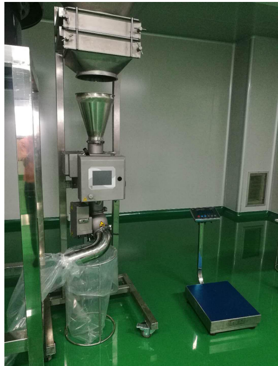
物料经过12000高斯磁筛 德国MESUTRONIC金属探测仪
